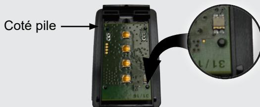
5) Remettre la carte électronique avec la nouvelle pile dans le boîtier. Les pattes de fixation et les dimensions de la carte électronique obligent à respecter le sens de montage.
