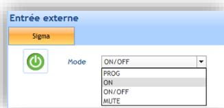
Le mode **PROG** permet de basculer l'état des programmations des circuits sélectionnés : un circuit en « marche » passe en « arrêt » (et vice-versa). Les circuits de relais sont sélectionnés un par un et il n'y a pas de sélection de zones ou de groupes possible (uniquement tous les carillons).
