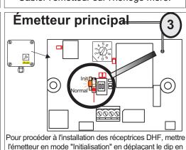
Pour procéder à l'installation des réceptrices DHF, mettre l'émetteur en mode "Initialisation" en déplaçant le dip en position "Init". La led orange clignote. Ce mode sera alors actif pendant 4 heures, au delà la led s'éteindra, et il vous faudra répéter l'opération pour continuer l'installation. Une fois toutes les horloges synchronisées, remettre le dip de l'émetteur en position "Normal".
