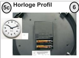
A l'emplacement où l'horloge est installée, mettre les piles en place. Après insertion des piles, le mouvement fait tourner les aiguilles pour aller sur une des trois positions : 4h/8h/12h. Dès la réception d'un bon message DHF, le mouvement avance ses aiguilles pour se mettre à l'heure.
