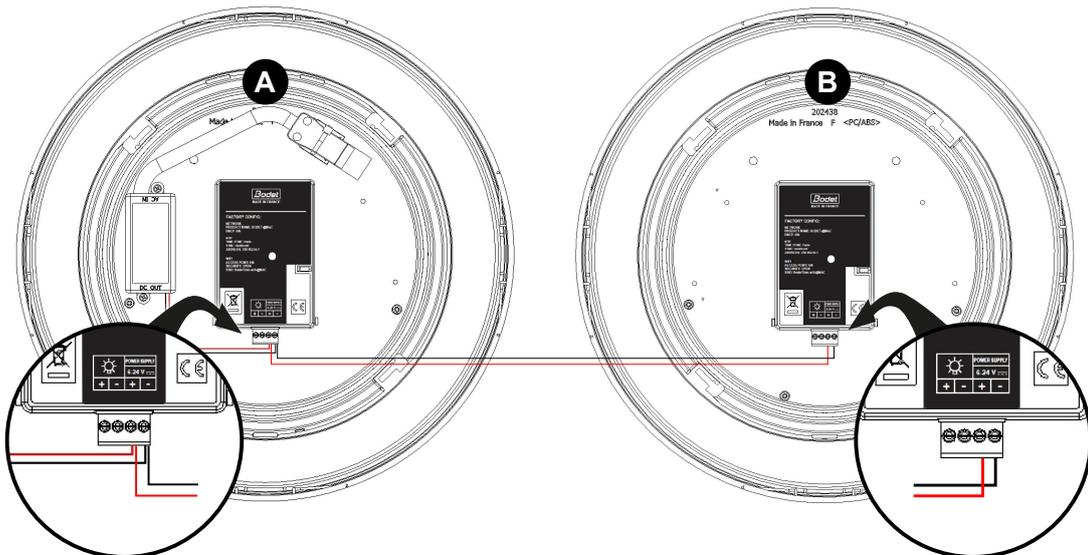
**i** Para el modelo de reloj de doble cara Profil 740 con retroiluminación o para el modelo de reloj de doble cara Profil 730 / 740 con dos relojes cada uno con una fuente de alimentación, es necesario duplicar el cable de alimentación (con un dominó) para luego hacer un cableado sencillo en cada uno de los dos relojes.
