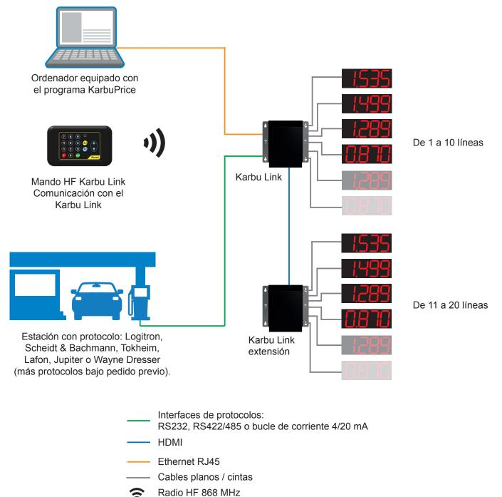
Para los combustibles, Karbu Link es universal y permite gestionar todos los colores, formatos, protocolos (interfaces de protocolos integradas) y dimensiones de líneas.
