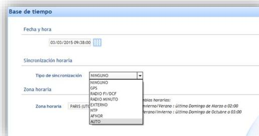
En el contexto de una distribución horaria, las distintas clases de sincronización permiten definir el modo de comunicación entre el reloj patrón y los relojes receptores.
