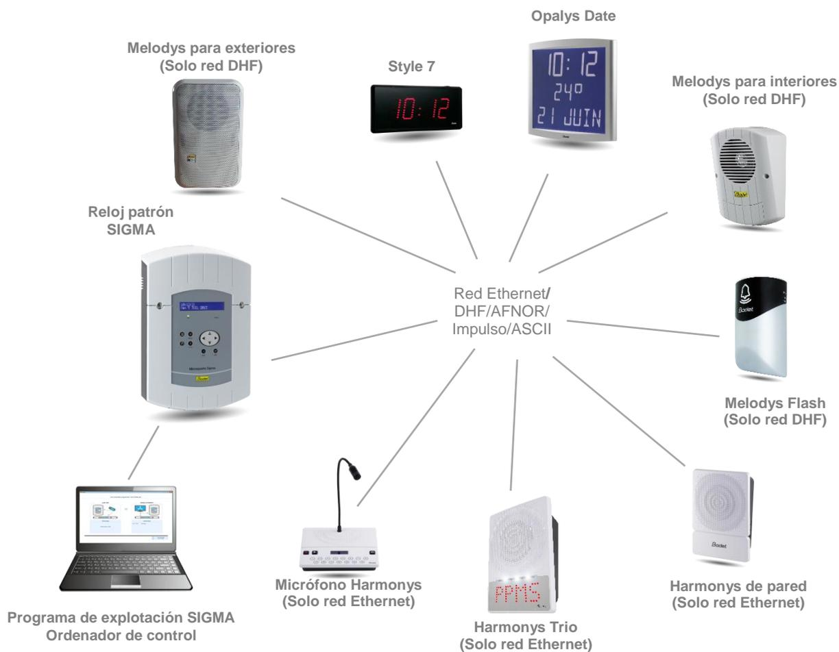
El programa Sigma se instala en un ordenador principal destinado a configurar los equipos de la red.
