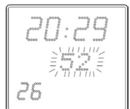
Ce dernier appui permet de sortir du menu de configuration. L'horloge revient alors au mode d'affichage correspondant à son utilisation normale.
