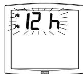
3. **Menu "Eco"**. Presser sur [+] pour choisir le mode normal "nor" ou le mode économique "Eco". Ce mode "Eco" efface l'affichage de l'horloge entre 23 h et 6 h (durée non paramétrable) pour économiser jusqu'à 20% de la charge des piles (conservation du clignotement des 2 points).
