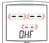
*Init* : force l'horloge à rechercher un émetteur DHF.
