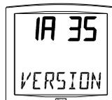
3. Appuyer sur le bouton [SELECT] pour afficher le menu du *type de synchro* (en fonction de la version). La touche [+] permet le choix entre *Ind* et *Sync* (si la carte synchro est présente) ou *Ind*, *DHF* et *DHFi*.
