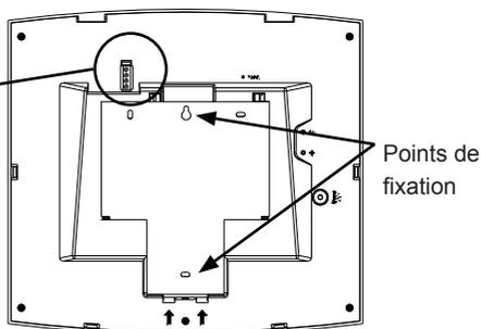
**!** L'alimentation externe doit être de type TBTS, de tension comprise entre 6 et 24 V AC/DC, 10 mA minimum, et conforme aux critères de source à puissance limitée du § 2.5 de la norme EN 60950 : 2000.
