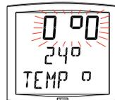
6. Appuyer sur [SELECT] pour obtenir le menu *Test afficheur*. Ce menu permet la vérification du bon affichage de tous les segments de l'horloge. Sur l'horloge *Cristalys Date* la touche [+] permet de faire défiler la table des caractères.
