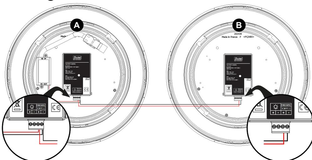
**i** Bei einem doppelseitigen Uhrenmodell Profil 740 mit Hintergrundbeleuchtung oder bei einem doppelseitigen Uhrenmodell Profil 730 / 740 mit zwei Uhren mit je einem Netzteil ist es notwendig, das Netzkabel zu duplizieren (mit einem Domino), um dann eine Verkabelung wie für eine einseitige Uhr an jeder der beiden Uhren auszuführen. Bei 2 Netzkabeln wird entsprechend vorgegangen: Schließen Sie jede Uhr wie eine einseitige Uhr an.
