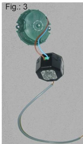
d. Connecter l'alimentation très basse tension venant du transformateur, sur le bornier au dos de l'horloge. Il n'y a pas de polarité à respecter.
