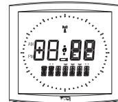
6. Appuyer sur [SELECT] pour obtenir le menu Test afficheur. Ce menu permet la vérification du bon affichage de tous les segments de l'horloge.
