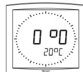
5. Appuyer sur le bouton [SELECT]. Réglage de l'offset de température.
