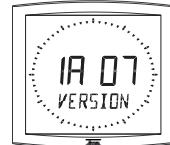
2. Appuyer sur le bouton [SELECT], et en le maintenant enfoncé, presser [-/+] pendant plus de 7 secondes pour passer en mode Technicien. La version du programme de l'horloge apparaît.
