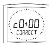
7. Appuyer sur [SELECT]. Le menu Correction s'affiche. Il permet de corriger manuellement la base de temps. En sortie d'usine, la valeur de l'offset est de 0. La valeur de cet offset peut varier (à l'aide de [+]) entre -999 et +999 par pas de 10ms (#0.12ppm). L'ajout de cet offset journalier à la base de temps sera réparti sur 24 heures.
