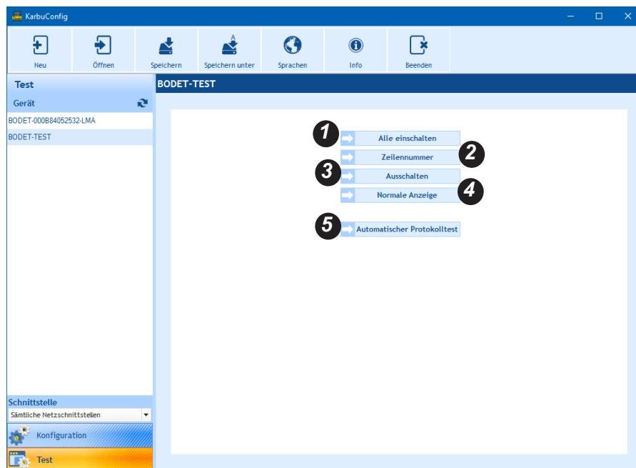
**1** Ermöglicht das Einschalten aller LED-Anzeigen eines Zeilenmoduls.
