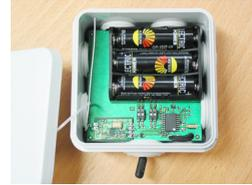
Es wird empfohlen, vor der Befestigung des Temperaturfühlers einen HF-Verbindungstest zu machen. Dübel und Stift anbringen, bevor er in das Gehäuse gesteckt wird. Der Fühler muss aus Dichtigkeitsgründen unbedingt nach unten zeigen.
