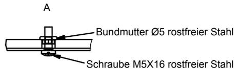
4/ Nur bei einem senkrechten Träger: die Trägerabdeckung an der Seite der Halterung für beidseitige Anzeige mit den 2 Schrauben Ø5 (Detail B) befestigen.
