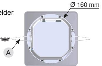
2/ Bringen Sie den Harmonys Melder zur Deckenmontage an seinem Platz an, das Ethernet-Netzwerk wird mit der Buchse RJ45 verbunden.
